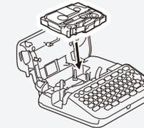
1. Inserte el casete de cinta de acuerdo con la ilustración situada debajo de la cubierta del compartimento del casete de cinta. Confirme que la punta de la cinta apunte hacia la ranura de salida de la cinta.
